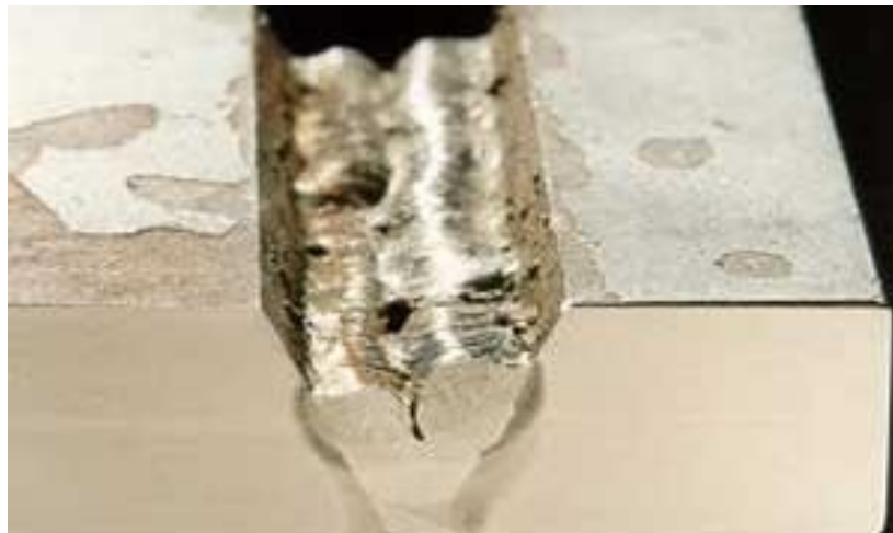
Figura 8. Fusión Incompleta entre Cordones de Soldadura
