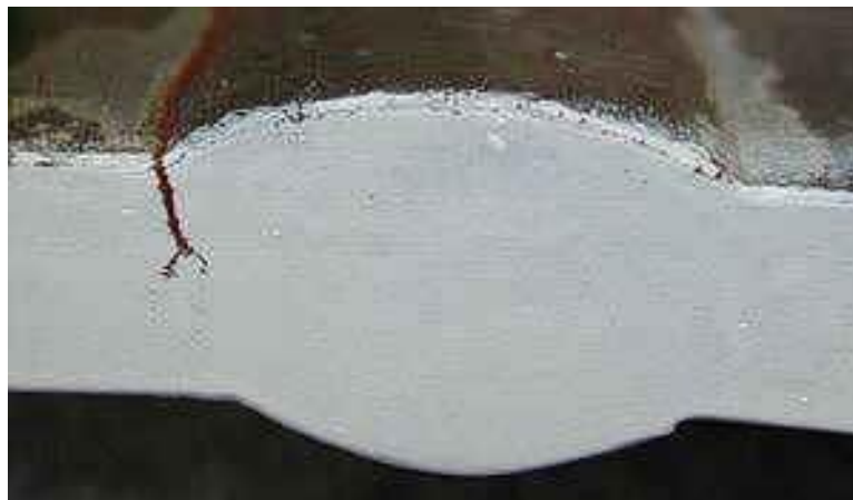
Figura 28. Grieta de Pie
