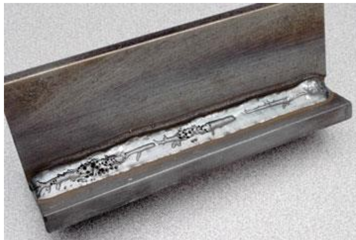
Figura 2. Apariencia Superficial de Porosidad de Agujero de Gusano (Wormhole)
