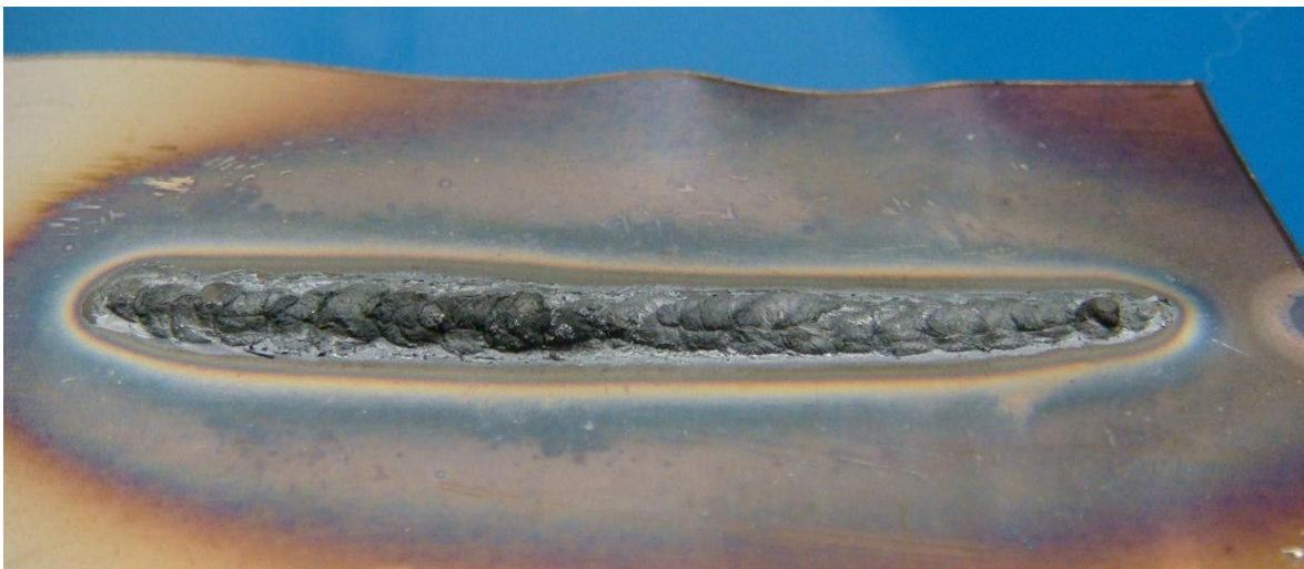
Figura 37. Oxidación Superficial (Azucarado) en Una Soldadura de Arco de Gas de Tungsteno en Acero Inoxidable
